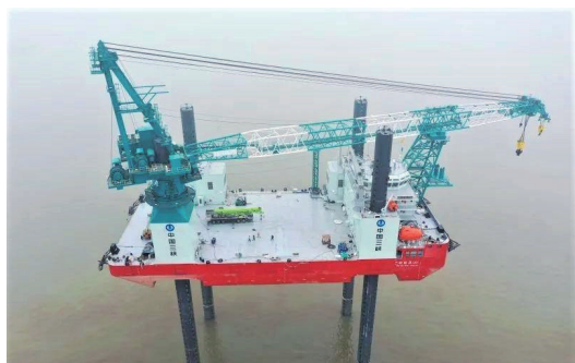
三峡 001 号 800T 浮吊
