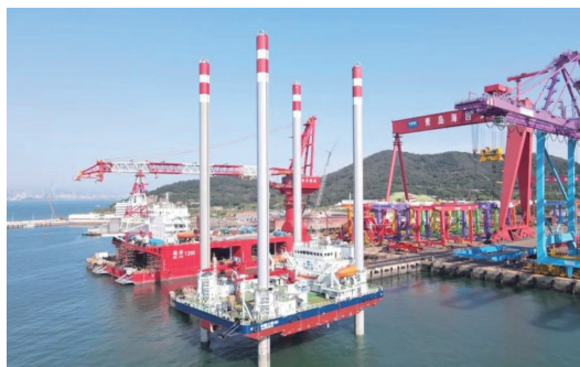
华东院 500T 电动齿轮齿条升降系统
